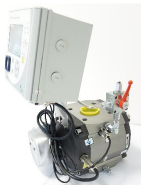
Obr. 10a | Svislá poloha instalace
