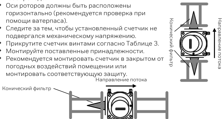
Рис. 11 | Установка конического фильтра
